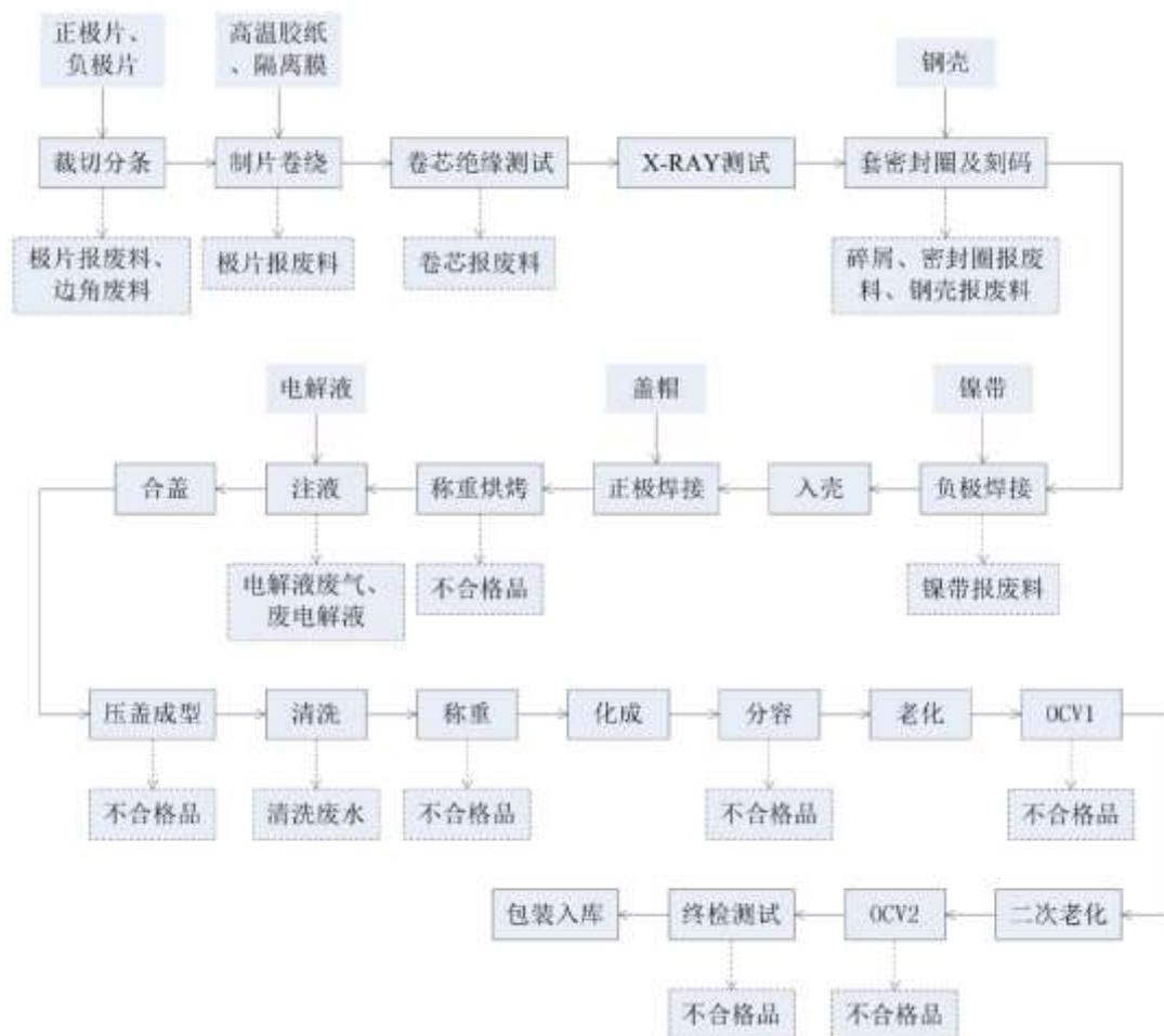
图 3-1 微型高性能锂离子电池生产工艺流程及产污环节示意图
